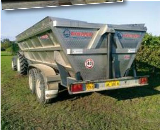
>> Vasca in acciaio inox per il trasporto delle uve di grande capacità.
