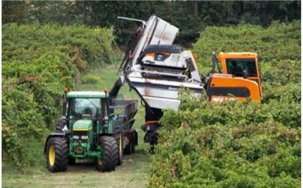
>> Scarico di uva diraspata da una vendemmiatrice semovente.
