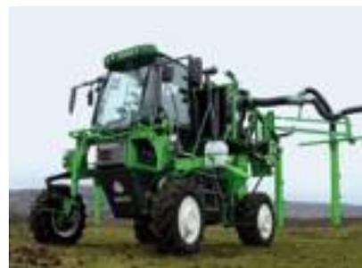
**Trattore scavallante a comando elettrico (medaglia d'argento).** Questo trattore scavallante elettrico, denominato Voltis, per lo stoccaggio dell'energia elettrica utilizza un tipo di batteria al litio-ferro-fosfato. Con un tempo di carica completo di 8-9 ore su rete elettrica standard, dispone di un'autonomia di 4-12 ore, in base alla natura dei lavori da eseguire, la velocità e la conformazione del terreno. Il piccolo gruppo elettrogeno di
