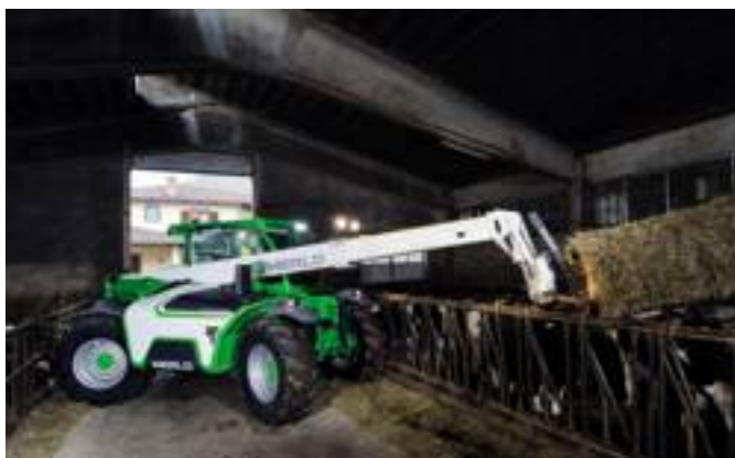
■ Negli spazi chiusi l'ibrido Merlo lavora in modalità 100% elettrico.
