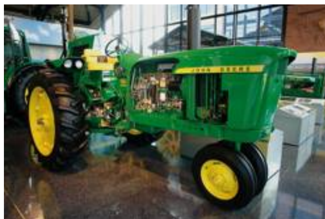
■ Il modello 4010 segna il passaggio di John Deere dal motore a 2 cilindri a quello a 4 e 6 cilindri.
