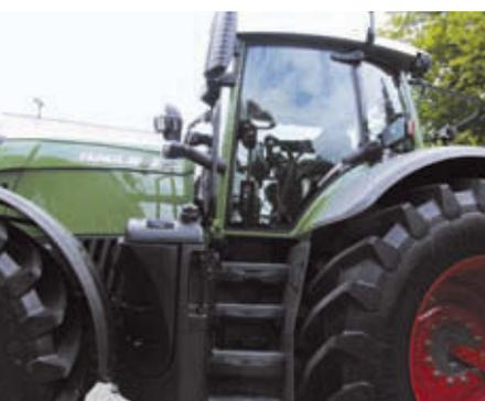
■ Fra le novità la cabina x5 S: cristalli laterali e parabrezza sono stati ulteriormente abbassati di 80 mm per migliorare la visibilità.
