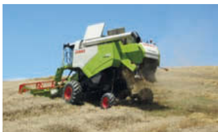
■ Il sistema di livellamento della nuova Tucano 430 Montana 4 permette di lavorare in pendenze del 38% laterale, 30% salita e 14% discesa.
