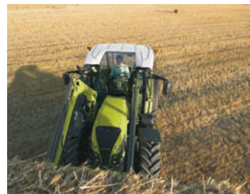
■ Nella cabina Panoramic, il parabrezza e il tetto in policarbonato, collegati fra loro senza giunzioni, offrono all'operatore un campo visivo maggiore di 90° sul caricatore frontale.
