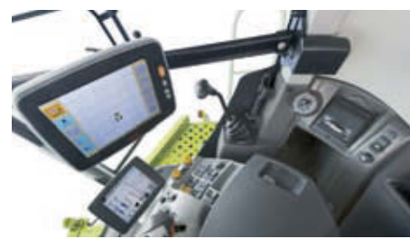
■ Con la nuova Tucano 430 Montana 4 per la prima volta anche sull'autolivellante è presente la leva di comando multifunzione CMotion.
