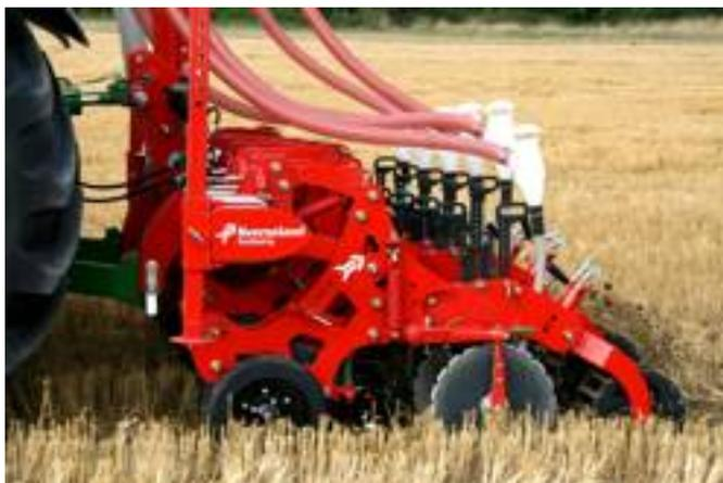
L'unità è provvista di un disco dal diametro di 520 mm per aprire il terreno e tagliare i residui più lunghi.
