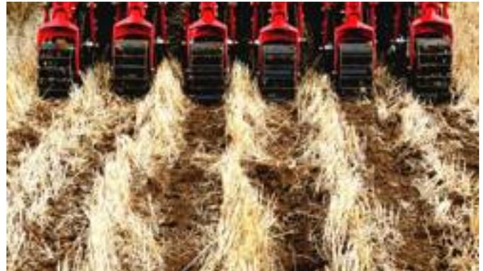
Il Kultistrip è costruito sulla base di un telaio robusto su cui è montata ogni singola fila dello strip-till. Ciò permette di variare la larghezza delle file da 45 a 75 cm.
