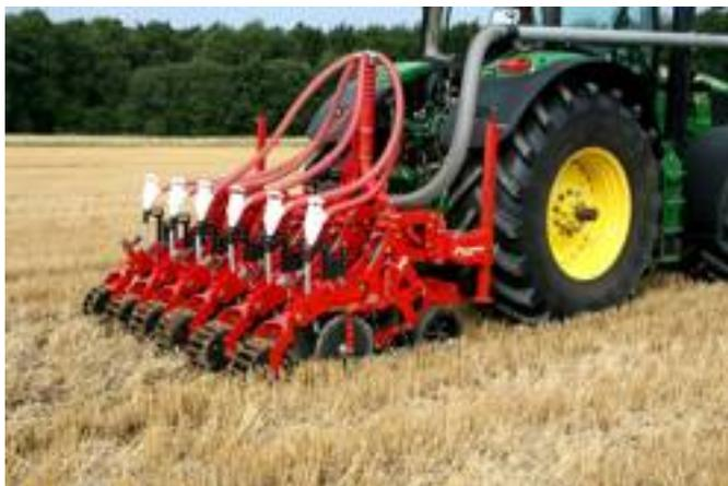
Strumenti finali del Kultistrip sono le ruote pressatrici - ruote dentate, ruote a gabbia e ruote Farmflex in gomma.
