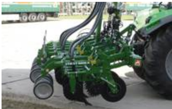
■ Realizzato in collaborazione con Vogelsang, il coltivatore a bande Xtill Amazone permette di lavorare e allo stesso tempo concimare con prodotto granulare la striscia di terreno su cui saranno depositi i semi.
