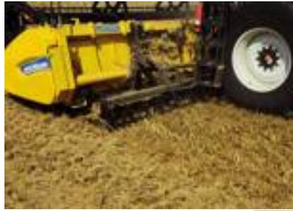
■ Dual Stream è in grado di aumentare fino al 15% la capacità complessiva della mietitrebbia e di ridurre il consumo di carburante anche del 15%.
