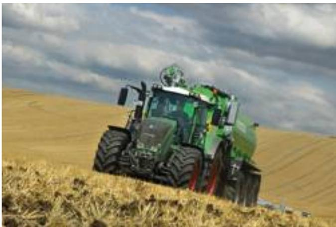
Nelle trattrici con maggiore potenza specifica la trasmissione è sempre di tipo continuo, gestita in sintonia con il motore.
