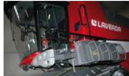
La scaletta può essere collocata in due posizioni durante le operazioni di raccolta: una soluzione molto utile per adattarsi alle condizioni del terreno.
