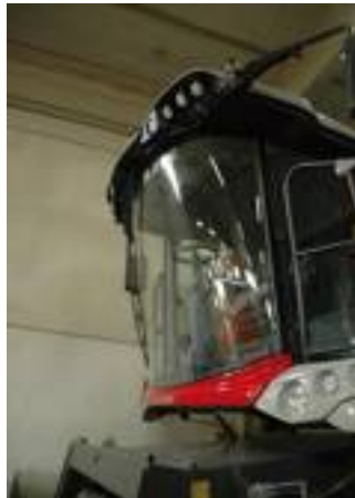
La cabina è stata insonorizzata con una speciale pellicola Pvb posta all'interno dei cristalli. È la stessa tipologia di pellicola in uso per insonorizzare i treni.
