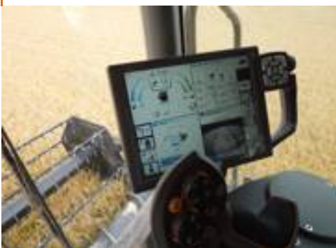
Il terminale da 10.4 pollici, touch screen, ma con anche i comandi fisici, permette un controllo totale della macchina.
