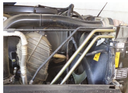
Ventola viscostatica di serie: assieme al sistema Scr contribuisce a mantenere bassi i consumi di gasolio.
