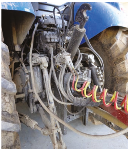
Il sollevatore posteriore ha una portata che supera le 10 tonnellate. A casa dei Sardo non è stato usato per l'aratura, ma soltanto per alzare e abbassare attrezzi.
