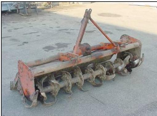
*Esempio di fresatrice agricola senza barriere*
