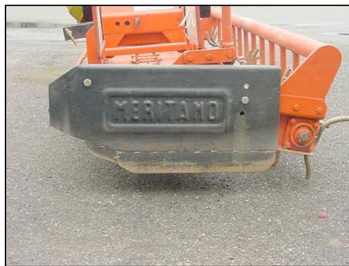
*Esempio di protezione laterale con  $a < 200$  mm*
