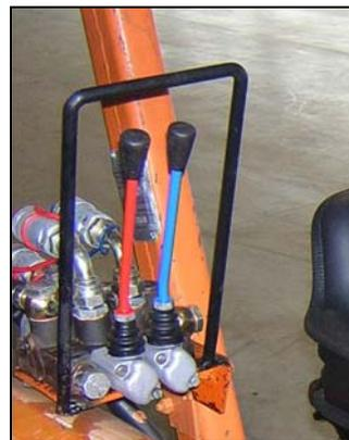
*Esempio di comandi con dispositivo anti-azionamento involontario*
