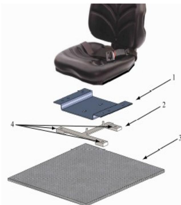
È necessario che la cintura di sicurezza sia allacciata sulla zona pelvica, per assicurare la trattenuta durante le condizioni di funzionamento e di ribaltamento.
